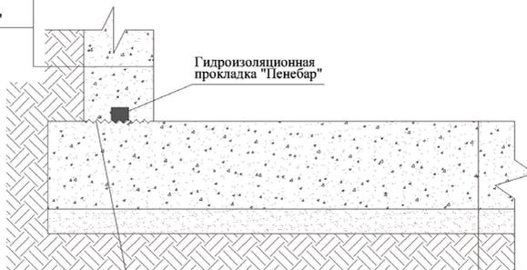
Монолитная бетонная плита
