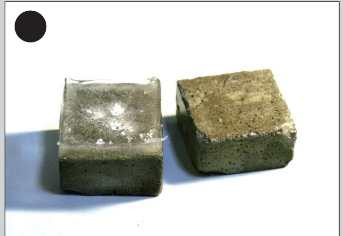
Первые признаки отслоения ледяного слоя от поверхности бетона на левом кубике появились после 15 ударов.
