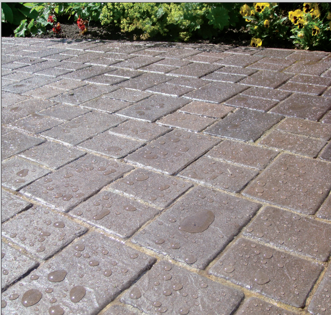
Внешний вид поверхности тротуарной плитки, защищённой гидрофобизатором Обработка гидрофобизатором проводится по предварительно очищенной поверхности. Наблюдается отсутствие смачивания поверхности и проникновения влаги в толщу материала и в межплиточные швы. Следствием этого эффекта в зимнее время является значительное уменьшение адгезии слоя льда к поверхности плитки.
