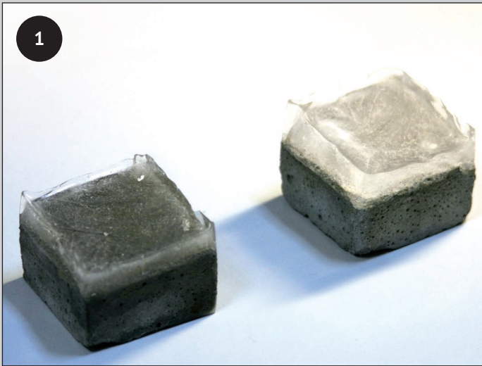
Правый кубик был обработан гидрофобизатором Типром У. Затем оба кубика покрыли слоем льда.
